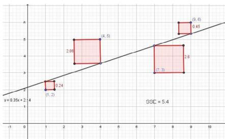
Abbildung 1: Lineare Regression und Fehlerquadrate für die Messpunkte (1|2), (4|5), (7|3) und (9|6)
