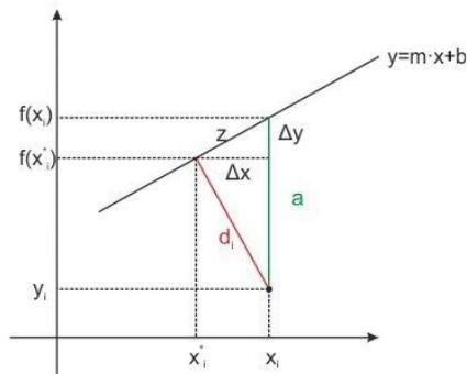
Abbildung 3: Abstand  $d_i$  eines Messpunktes zur Regressionsgerade.
