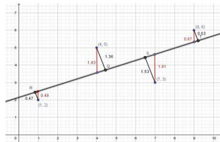
Abbildung 2: Vertikale Abweichungen im Vergleich zum orthogonalen Abstand.
