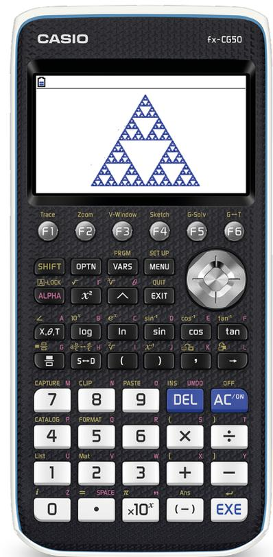
Zur Berechnung der Zufallszahlen muss das Modul **random** eingebunden werden. Bei diesem Programm wird vorausgesetzt, dass das CASIO-Modul **casioplot** zur Verfügung steht, also das Betriebssystem in der Version 3.40 installiert ist. Die Zeichenebene für **casioplot** hat die Eckpunkte (0,0), (0,191), (383,191) und (383,0).
